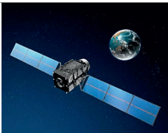
▲ Figura 1, En conjunto con los sistemas GNSS con cobertura global, los satélites QZSS circularán en una órbita cercana al zenit que permitirá un posicionamiento más preciso y más fiable en corredores urbanos de Japón (fuente: Jaxa, modificada).
